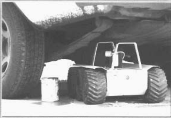
Рис. 1. Малые размеры МРК-01 позволяют использовать его для осмотра днища автомобилей
